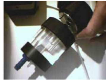
Naczyniem elektrody i grzejnik
